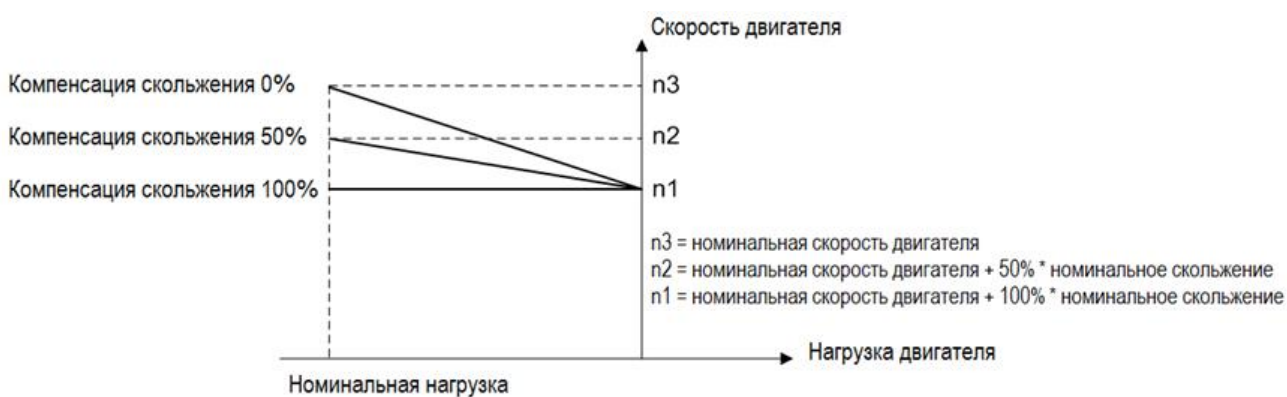
Компенсация скольжения в генераторном режиме
