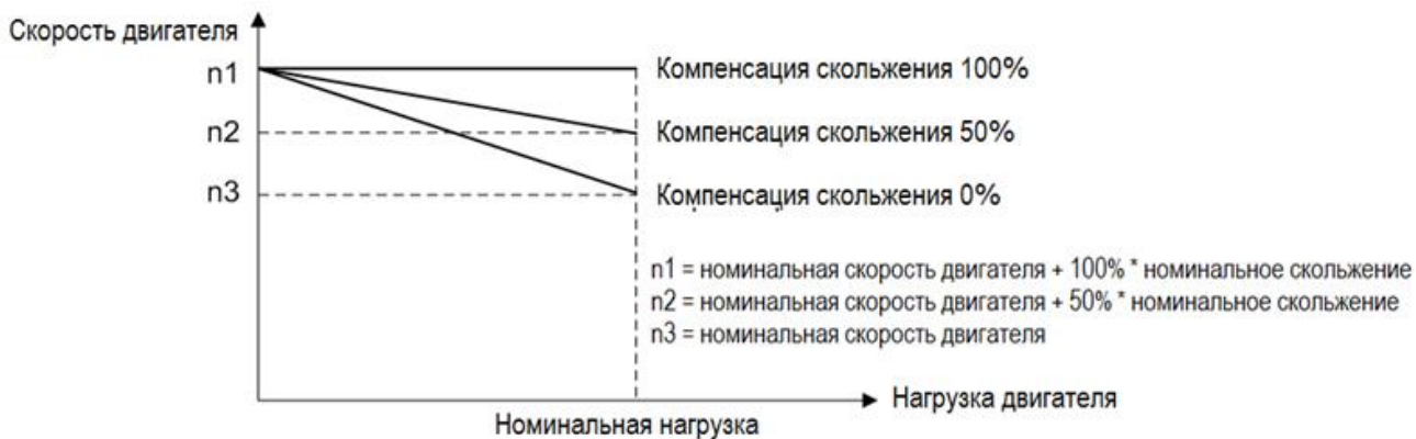
Компенсация скольжения в режиме вращения двигателя
